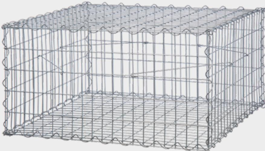
Die geschweißten RANKO® Gabionengitter sind gefertigt aus stabilem 4,5 mm Zink-Alu-Draht. Die Maschenweite beträgt 100 x 50 mm oder 100 x 100 mm, sodass sich als Füllmaterial mittelgroße Steine eignen. Die Größe der Körbe reicht von 500 x 500 x 500 mm bis 2000 x 1000 x 1000 mm.
